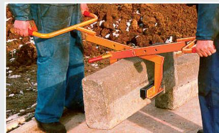
\* Mögliches Maß zwischen den Greifbacken. Produktmaß muß um ± 30 mm innerhalb des angegebenen Bereiches liegen
