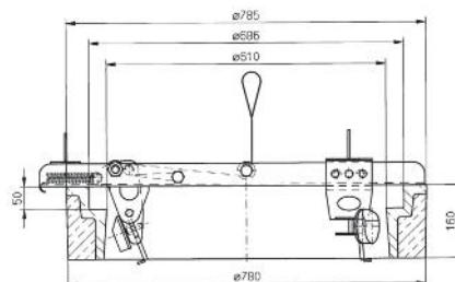
\*Die Lüftungsöffnungen der Hersteller sind nicht genormt. Daher kann nicht garantiert werden, dass die beiden Lasthaken für jeden Deckel passen.
